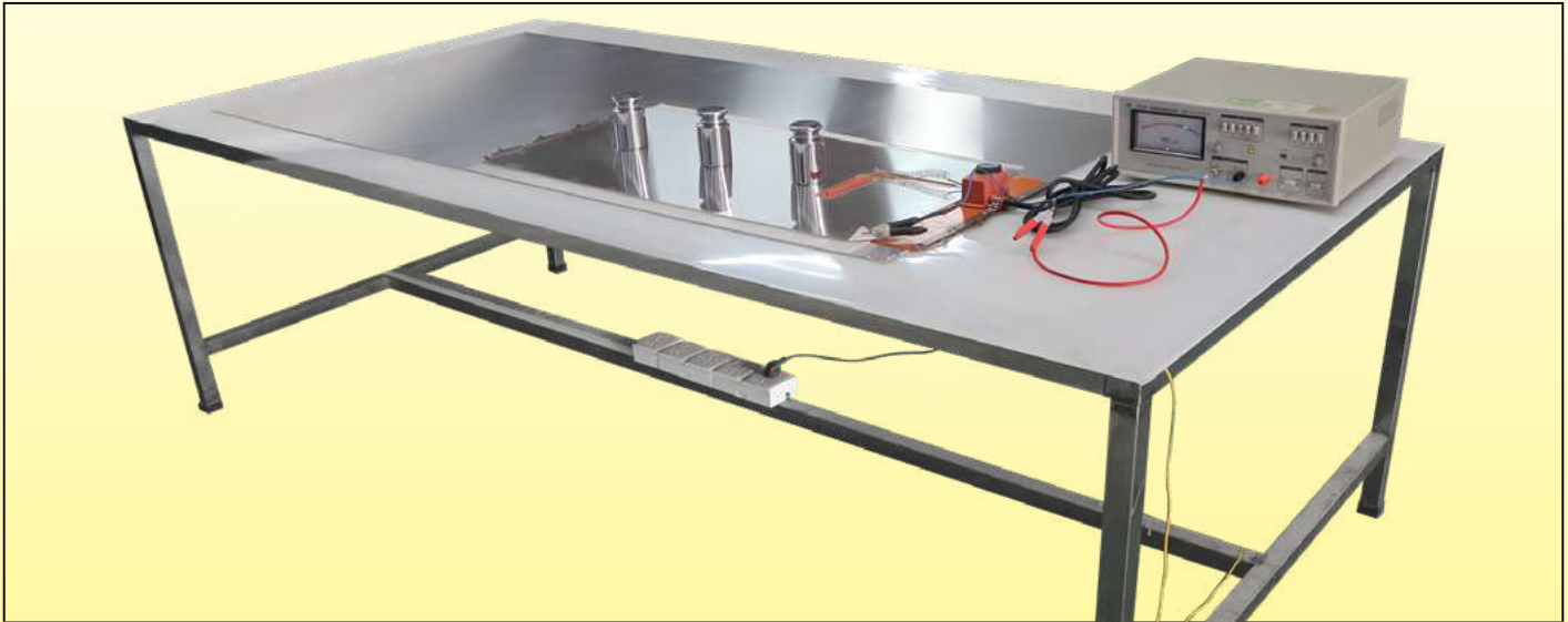
Прибор для измерения сопротивления изоляции. Измеренные значения всегда больше 0,1 ГОм
