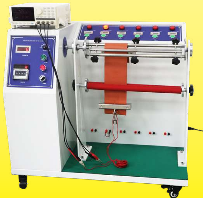
Гибкий силиконовый нагреватель при проведении испытания на сгибание
