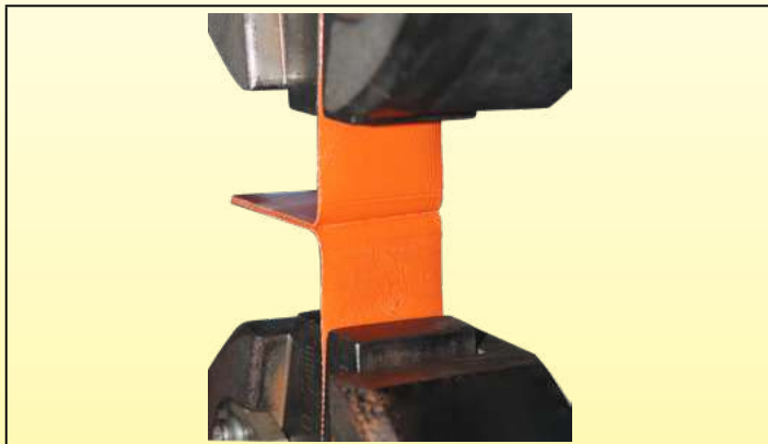
Вулканизированный образец перед испытанием на развязку
