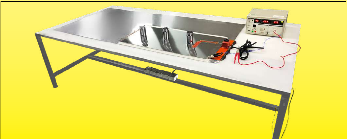
Измерительное оборудование для измерения полного тока утечки в холодном состоянии
