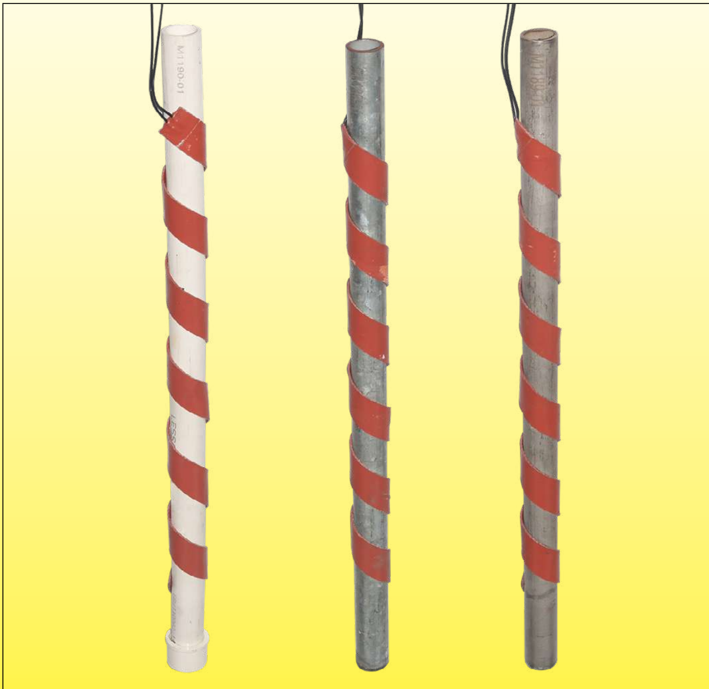
Условия проведения сравнительных испытаний: силиконовые нагревательные ленты, намотанные на трубки наружным диаметром 25 мм из PVC-U, оцинкованной и нержавеющей стали
